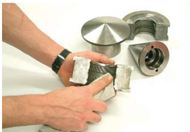
Отбортовочный конус и зажимная пара тщательно очищаются перед началом процесса отбортовки.
