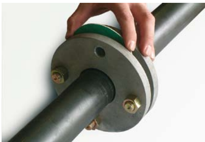
Болты используются для центрирования уплотнения.
