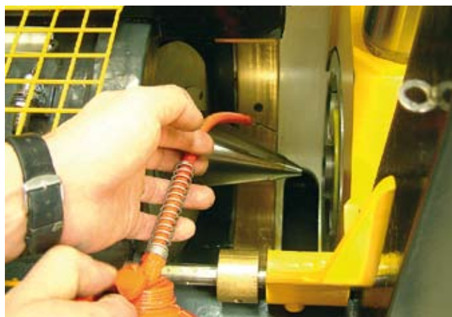
На конус и внутреннюю кромку трубы наносится смазка.
