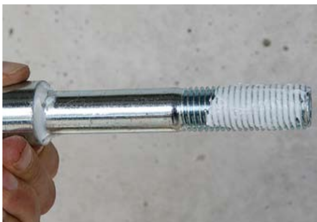
Смажьте резьбу болтов так, как показано на картинке. Если вы затягиваете болт без гайки – смажьте также торец головки болта. Если вы затягиваете болт с помощью гайки – смажьте гайку со стороны фланца.
