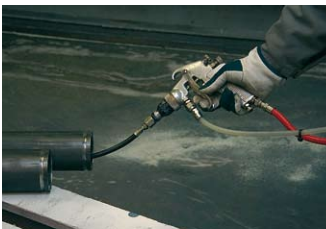
Трубные модули обрабатывают маслом для того, чтобы предотвратить образование коррозии во время транспортировки и хранения.
