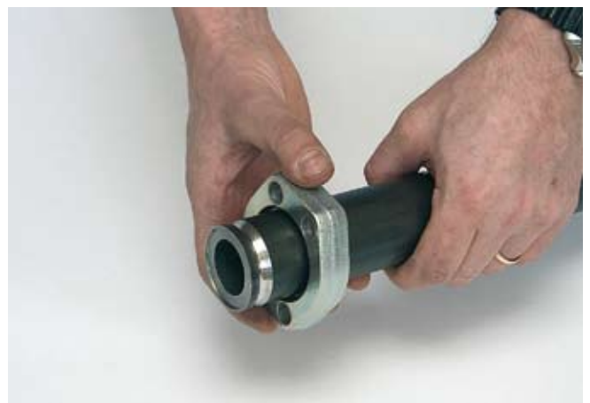
Установите фланцы гладкой стороной к месту проточки канавки на трубе. Оригинальный GS-фланец имеет соответствующую маркировку: тип и номер фланца.
