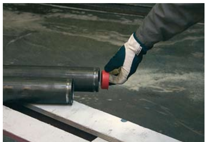
Перед отправкой на концы труб устанавливают надежные заглушки.
