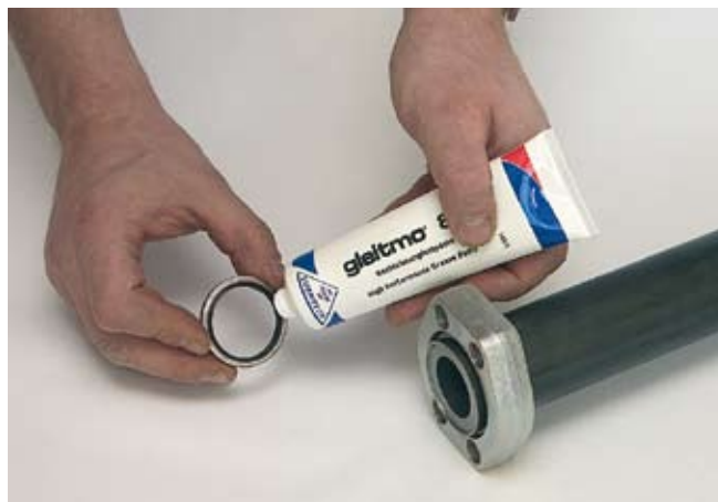
Смажьте армированное уплотнение пастой Gleitmo 805 или ее аналогом. Следите за тем, чтобы концы труб соответствовали друг другу и плотно прилегали к уплотнению.
