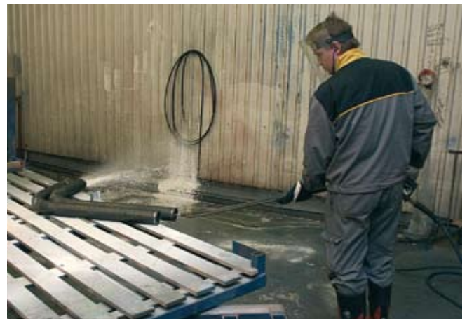
Подготовленные трубные модули обрабатывают паром 110°C-130°C (с добавлением химического очистителя).
