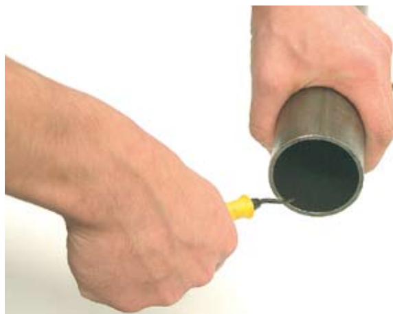
Торец трубы тщательно зачищается от заусенцев с наружной и внутренней кромок.
