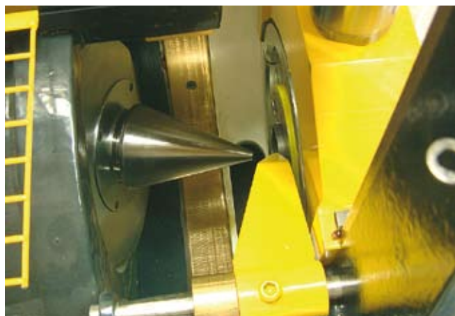
Конец трубы помещается в зажимную пару, соответствующую по размеру отбортовываемой трубе.
